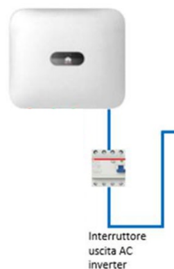
Figura 1.2: interruttore in uscita CA dall'inverter
